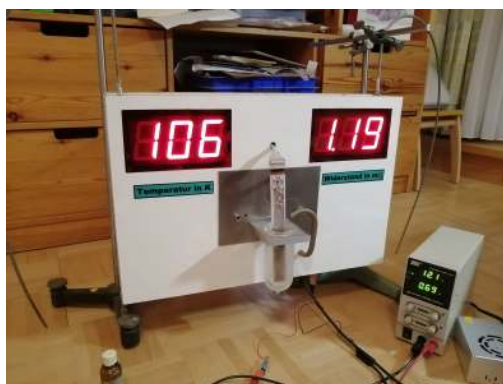
Abbildung 14: Widerstandsmessung bei einer meiner YBCO-Proben [Eigene Abbildung]
