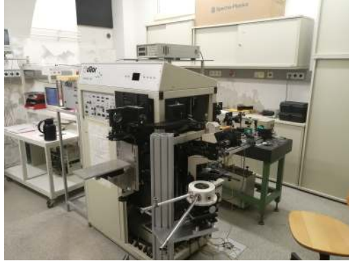
Abbildung 15: Raman-Spektroskop am Institut für Experimentalphysik der Karl-Franzens-Universität Graz [Eigene Abbildung]
