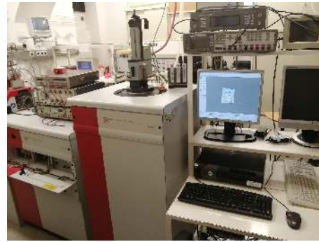
Abbildung 28: (a) Prinzip eines DC-Squids [Schill u. a., SQUID Magnetometrie , S. 4]; (b) SQUID-Magnetometer am Institut für Experimentalphysik der Karl-Franzens-Universität Graz [Eigene Abbildung]
